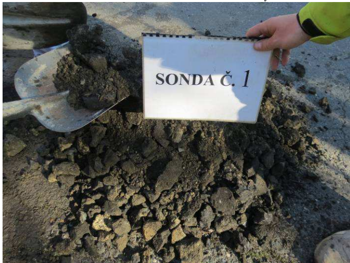
Obr.3.F Sonda č.1 – štět v úrovni zemní pláně
