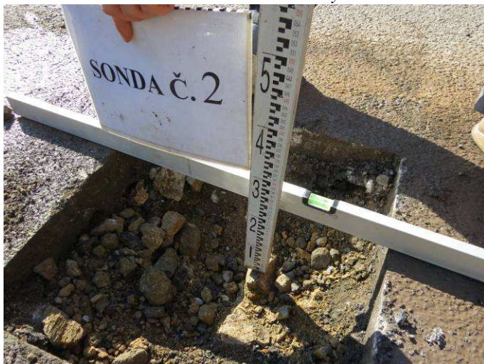
Obr.5.F Sonda č.2 – materiál konstrukční vrstvy
