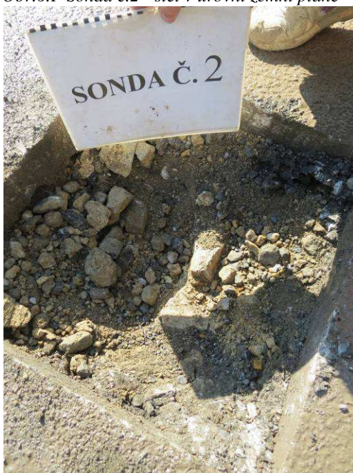
Obr.6.F Sonda č.2 - štět v úrovni zemní pláně
