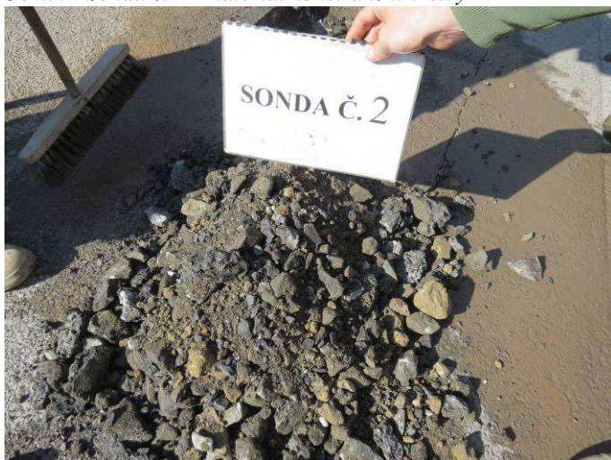
Obr.5.F Sonda č.2 – materiál konstrukční vrstvy
